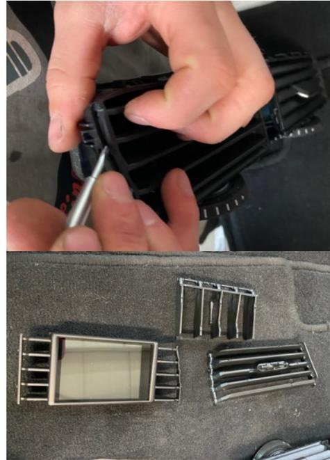
Unten in die Luftführung ein Loch bohren, wo sowohl Anschlusskabel als auch USB-Kabel hindurchpassen:
