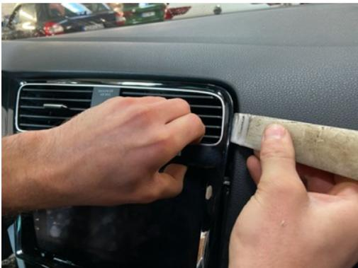
Der linke Bereich der Hochglanz-Blende zum Tacho ist ebenso geklipst und muss abgehebelt werden.
