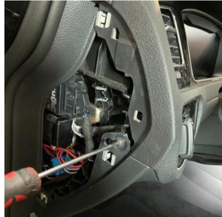
Nun die untere Abdeckung an den 4 Punkten abschrauben und entfernen
