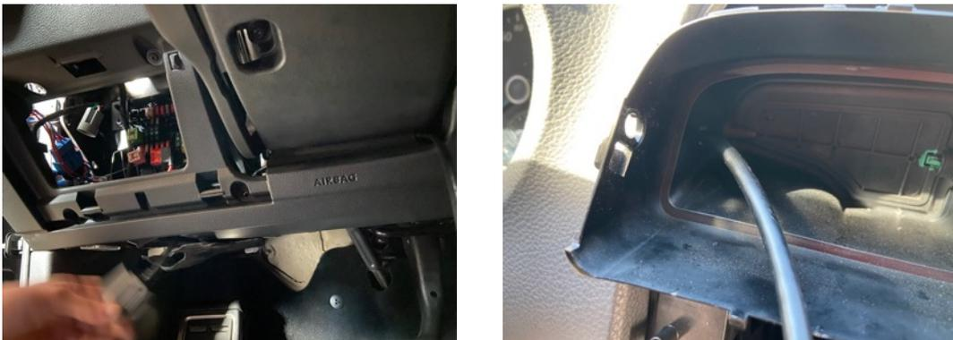
Ist das Anschlusskabel noch nicht in die Stecker eingepinnt, dann dies bitte jetzt durchführen. Hier ist auf die korrekte Position zu achten und dass der Pin leicht einrastet. Anschließend die Stecker am Display anstecken.
