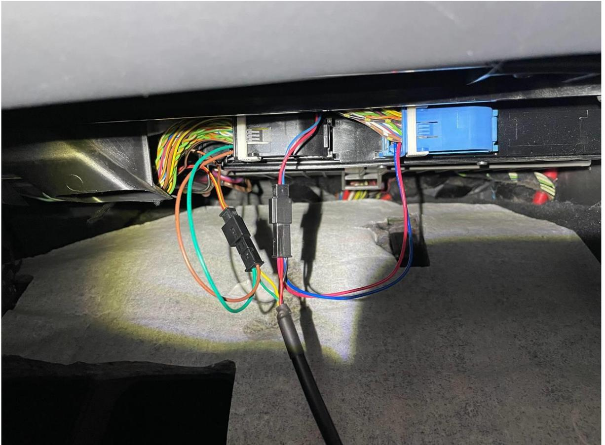
Bevor nun die Finalisierung des Zusammenbaus durchgeführt wird, kann das Display an dieser Stelle auf vernünftigen Anschluss geprüft werden. Startet es einwandfrei und ist die Can-Kommunikation gegeben kann die Blende final eingeklipst und die Verkleidung des Fußraumes wieder festgeschraubt werden.
