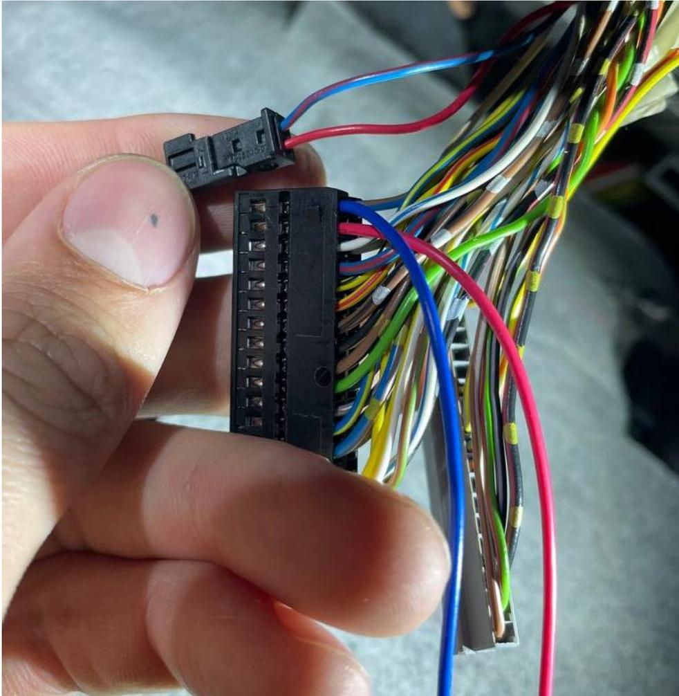
Die originalen Pins steckt man in die mitgelieferten Stecker, so dass die gegenüberliegende Farbe vom Kabel gleich ist: rot/blau auf rot/blau und rot auf rot.
