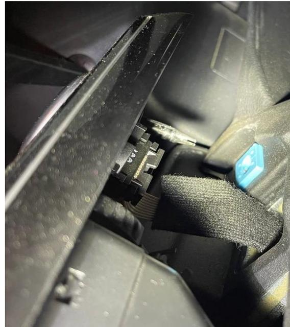
Nun kann die gesamte Blende entnommen und für den Einbau des Displays vorbereitet werden. Dazu müssen die Ausströmer der Lüftung von der vorderen Blende trennt werden. Nach dem Demontieren der Hebelmechanik zur Verstellung der Klappen (gelb) müssen die beiden Muttern (rot) entfernt und die Blende noch rundum entclipst (blau) werden.
