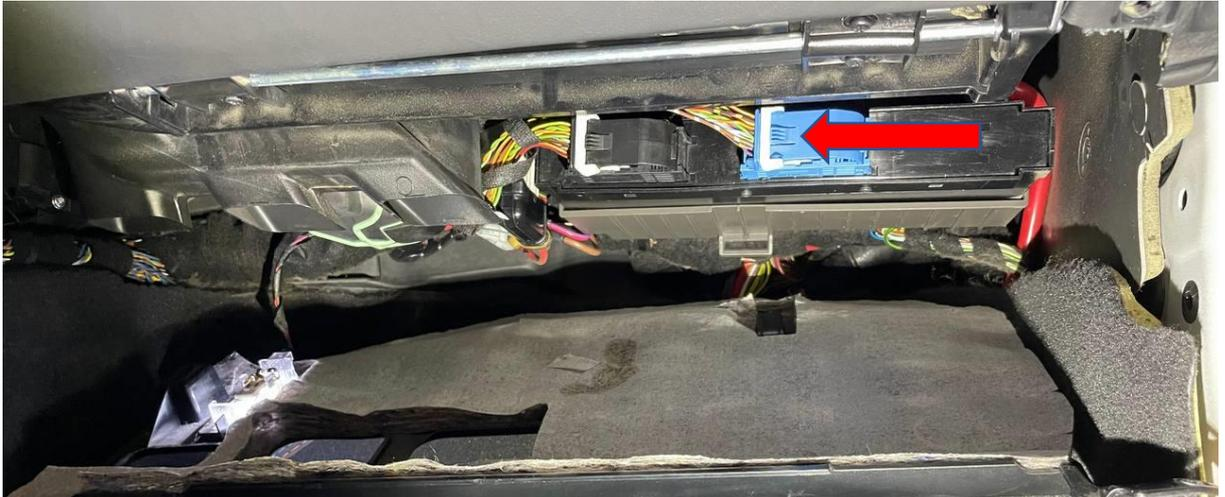
Um den Einsatz herauszuziehen, muss das Steckergehäuse an beiden Seiten leicht auseinandergebogen werden, damit die markierten Haltenasen herauschnappen:
