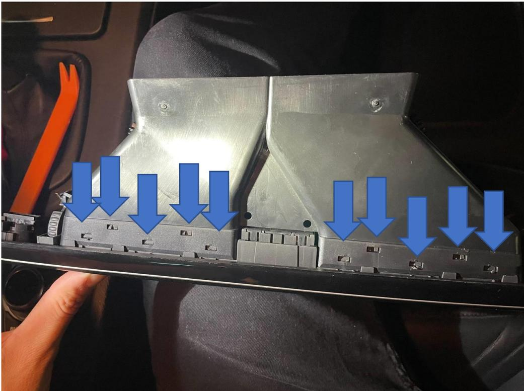
Jetzt können die Lamellen und das zweite Innenteil aus dem Kanal entfernt werden.
