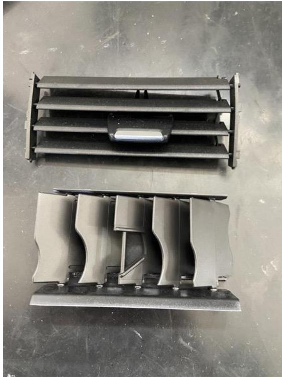
In die Unterseite der Luftführung zwei Löcher nebeneinander bohren und mit der Feile ausarbeiten, sodass, USB-Kabel und das Anschlusskabel durchgeführt werden können:
