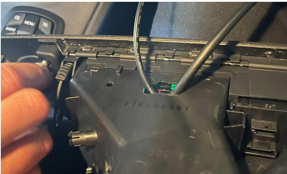
Die Anschluss-Kabel am Display einstecken (Plug A und Plug B), sowie das USB-Kabel und mit der Durchzugshilfe (Kabel) in Richtung rechtem Fußraum durchfädeln.
