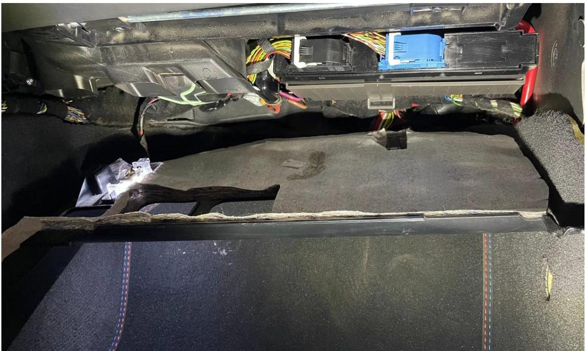
Der Stecker der Fußraumbelichtung muss nicht zwangsläufig entfernt werden, es reicht die Verkleidung zu lösen und in den Fußraum zu legen.
