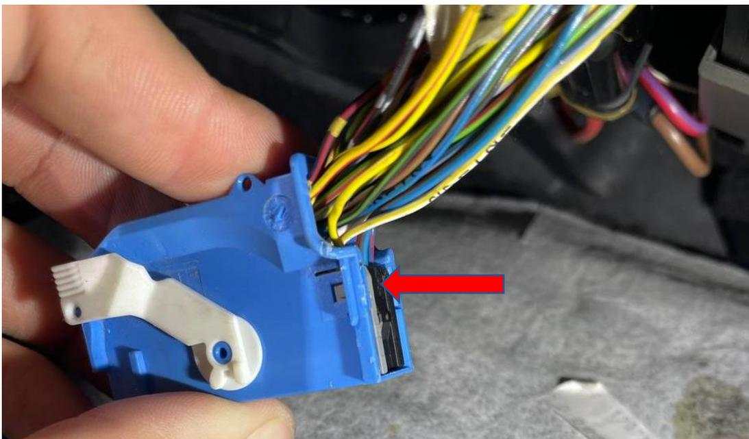
Wir benötigen Pin 1 (blau/rot – Can High) und Pin 2 (Rot – Can Low). Am unteren Pfeil ist der Pin eingehakt. Die Verankerung drücken und vorsichtig am Kabel den Pin herausziehen. Manchmal bleibt der Pin am zweiten Pfeil hängen – dort dann auch nochmal entriegeln:
