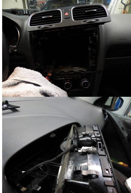
Den weißen Stecker abstecken und die Kabelbefestigung ebenso lösen. Nun kann die Lüftungsblende komplett entfernt werden.
