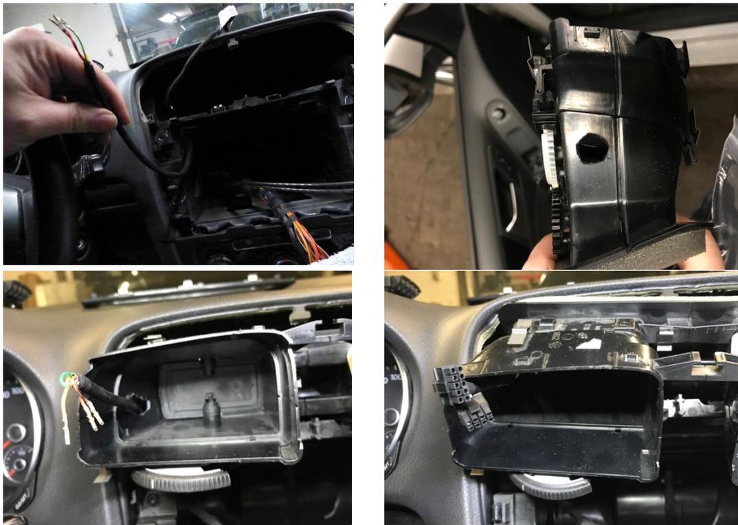
Als nächstes schiebt man die Pins in die Stecker des Displays. Hier ist auf die korrekte Position zu achten und dass der Pin leicht einrastet.
